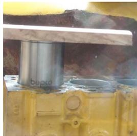
Beispielsweise wurde für einen Motor eine austauschbare Manschette für die Zylinderbohrungen entwickelt. Dies erlaubt es, beim Auffrischen die Manschette zu ersetzen anstatt eine Zylinderbohrung vornehmen zu müssen, welche den Durchmesser vergrößern würde. So kann der Motor mit demselben Kolbendurchmesser wieder eingesetzt werden.
